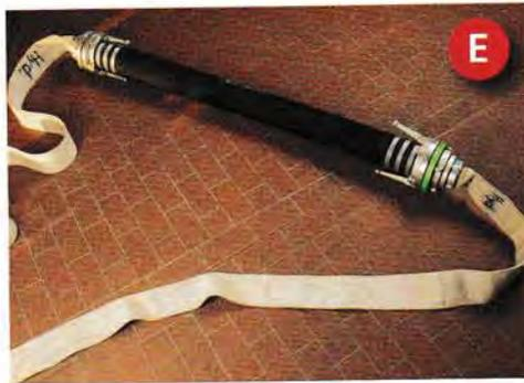
Saugleitung oder Druckschlauch – da muss man sich schon entscheiden. Die beiden Schlauchvarianten der Feuerwehr unterscheiden sich in ihrem Aufbau und ihrer Funktion. In der wilden Schlauchmischung steckt der Fehler.
