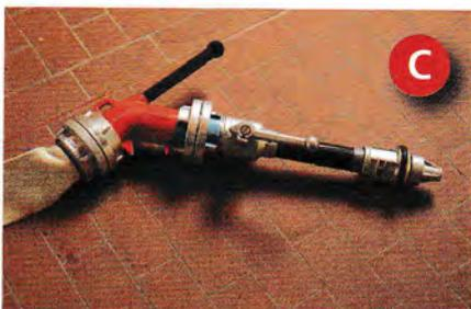
Bei unserem Bild C wurde der Stützkrümmer entgegen seiner vorgegebenen Einbaurichtung zwischen Schlauch und Strahlrohr gekuppelt. So eingebaut können das Strahlrohr und die enorme Wasserkraft nicht sicher gehalten und geführt werden. Einzig zum Bau eines Behelfsmonitors – bei dem der Stützkrümmer auf dem Boden liegt – wird diese wasserführende Armatur entgegen der gekennzeichneten Durchflussrichtung eingebaut.
