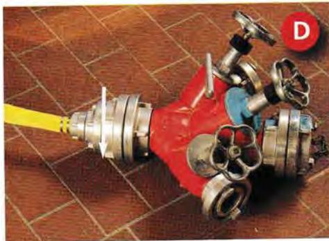
Bei Bild D hat wohl jemand den Begriff Reduzierstück falsch verstanden und eine D-Leitung an einen B-CBC Verteiler angekuppelt... Ein Verteiler kann seine Funktion nur dann in vollem Umfang erfüllen, wenn die ankommende Leitung einen größeren oder mindestens gleichen Volumenstrom liefert, wie die abgehenden Leitungen.
