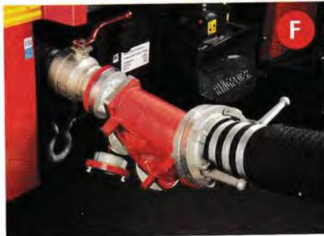
Was wird denn hier gesammelt? Das Sammelstück dient der Zusammenführung von Löschwasserströmen (beispielsweise von Hydranten) und wird meistens am Pumpeneingang der Feuerlöschkreiselpumpe angekuppelt. An einem Abgang macht diese wasserführende Armatur keinen Sinn.
